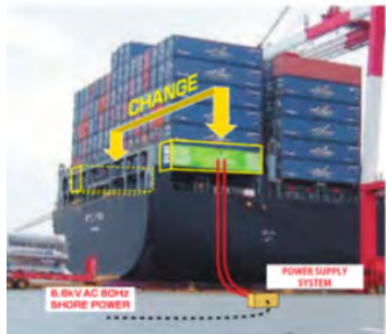
停泊中船舶への陸上電力供給
