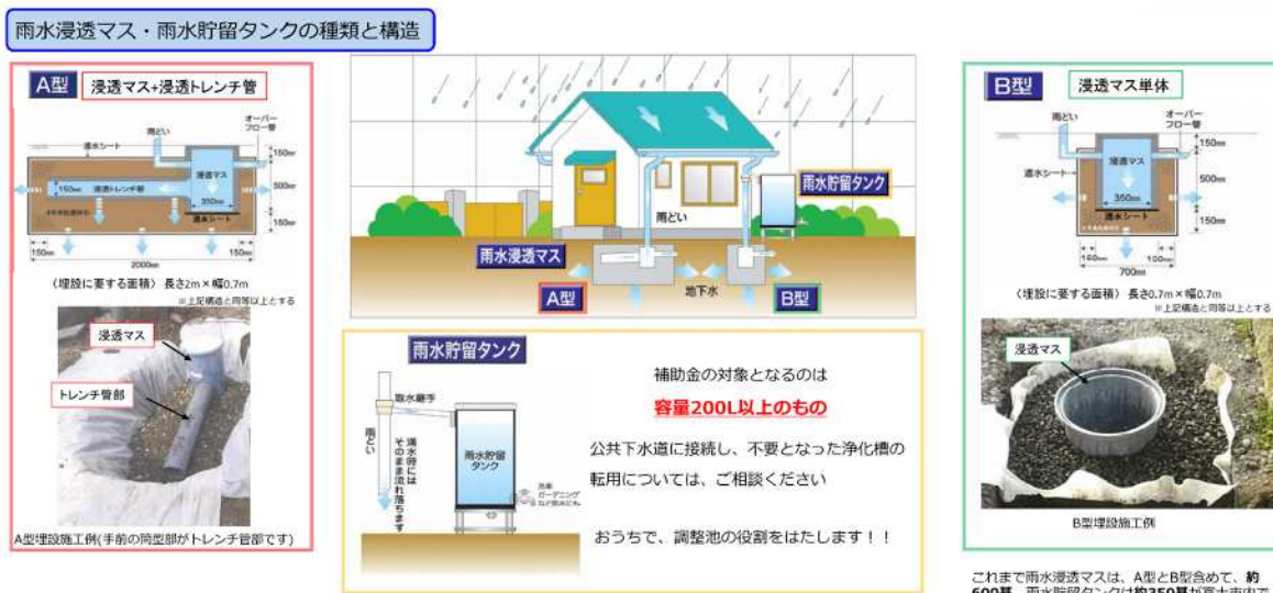
図 5.11 雨水浸透施設・貯留施設の概要
