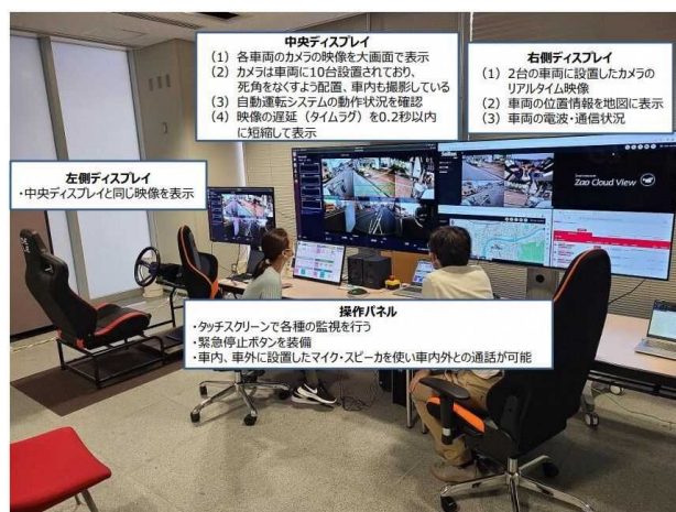
▲遠隔コントロールセンターの機能
