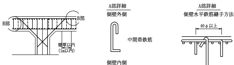
図 10-19 側壁水平断面の配筋
