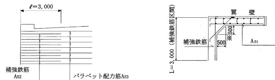
図 4-33 ウイング接続部の補強の例
