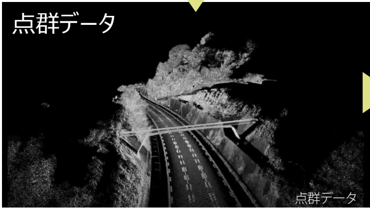
MMS モバイルマッピングシステム (移動式高精度三次元計測システム)
