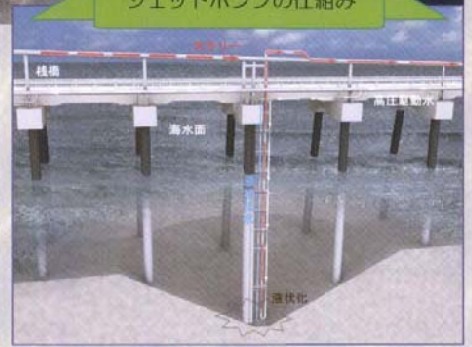
ジェットポンプの仕組み
