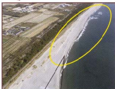
沿岸漂砂バランスの乱れにより砂浜が侵食
