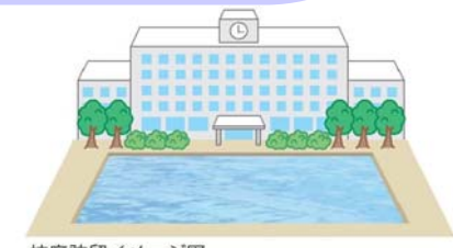
校庭貯留イメージ図 注) 時間雨量68mm(確率規模W=1/20相当)の大雨時に30cm程度、雨水を一時的に貯留します。 ※校庭貯留8校および沼原川調整池は、貯留容量が少なく、今ノ浦川の水位低下効果は小さいが、周辺の浸水被害の軽減に効果があります。
